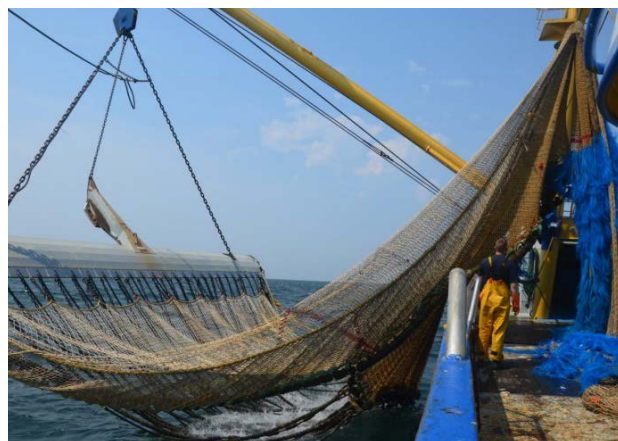
Chalut de fond équipé d'électrodes pour pratiquer la pêche électrique
