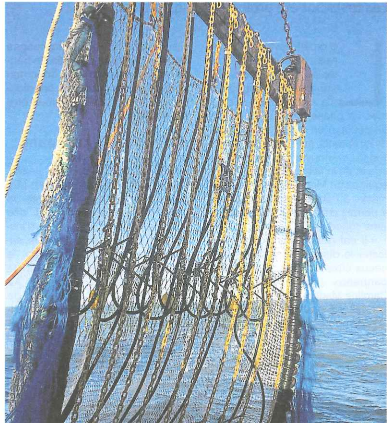
Le waterspray est un engin de pêche équipé d'une pompe électrique sur le tuyau et des buses qui soulèvent le poisson du fond à l'aide de jets d'eau.
